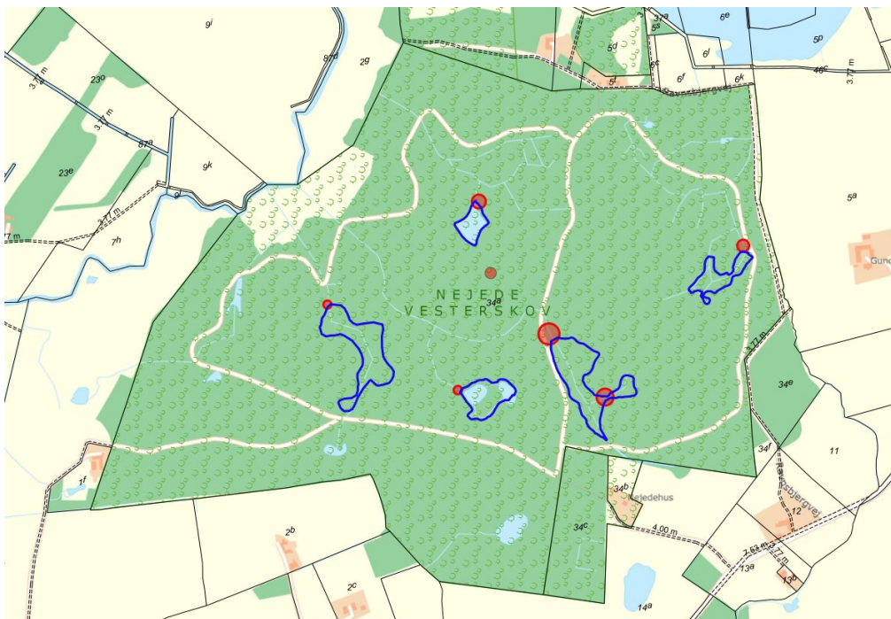
Figur 4. Projektområdets placering inden for fredskov (fra projektbeskrivelsen). Med rødt er markeret de slutpropper, der blokerer de tidligere afvandingsgrøfter. Med blå er markeret de arealer, der forventes oversvømmet i projektet. Matrikelskel er markeret med sort streg og fredskov er markeret med grøn skovsignatur. Baggrundskort © Geodatastyrelsen.
